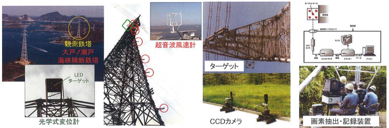
圖 3-1 鐵塔設置偵測感應器及設備監測示意圖(JST 公司提供)
