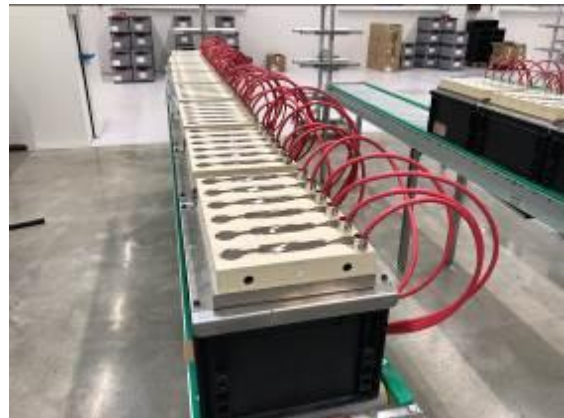
圖 4-6 計軸器自動化灌封(Potting)
