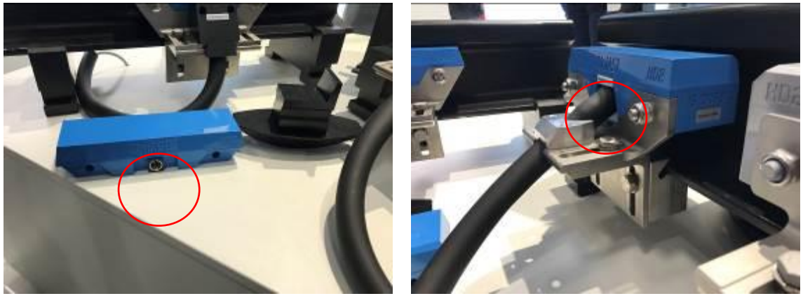
圖 3-5 計軸頭與連接之纜線設計為插拔式方式
