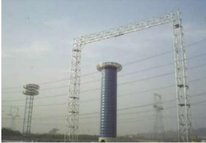
圖 16 7500kV 戶外衝擊試驗場
