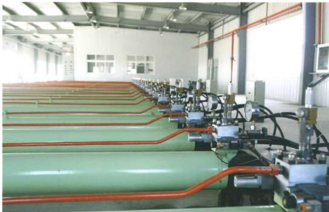
圖 23 液壓加荷系統
