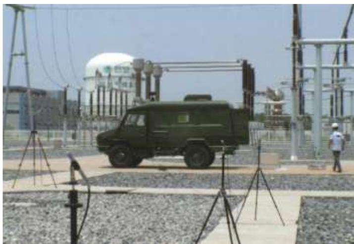
圖 15 特高壓交流試驗基地運行電磁干擾測試車性能測試
