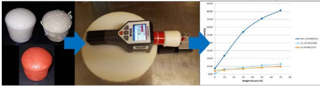
圖 13 市售發泡材料測試其阻擋輻射能力
