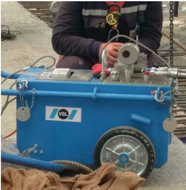
圖 3-4-9 Liman 高架橋懸臂工法預力系統施拉設備
