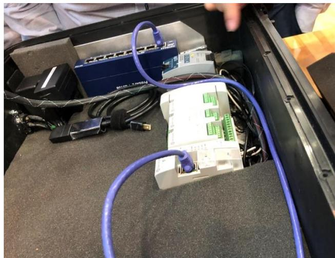
圖5 簡易控制系統內部元件
