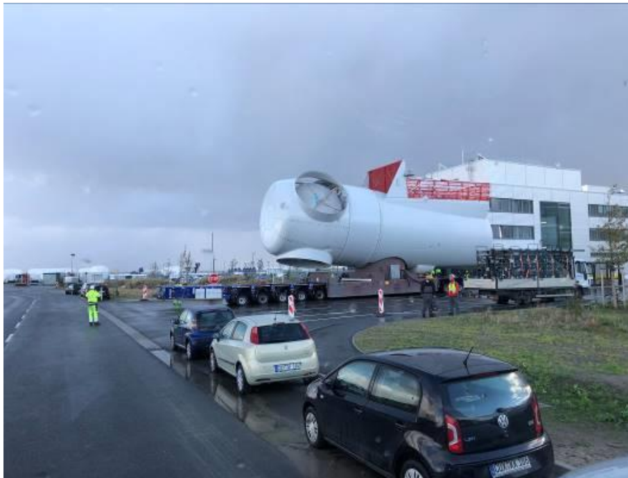
圖 1：7MW 機組自工廠大門使用 SPMT 運輸狀況
