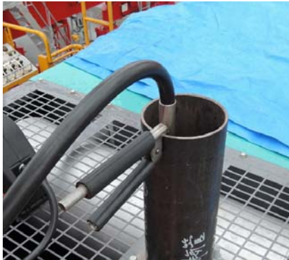
プローブ取り付け状態の一例 (レバー方式による固定)
