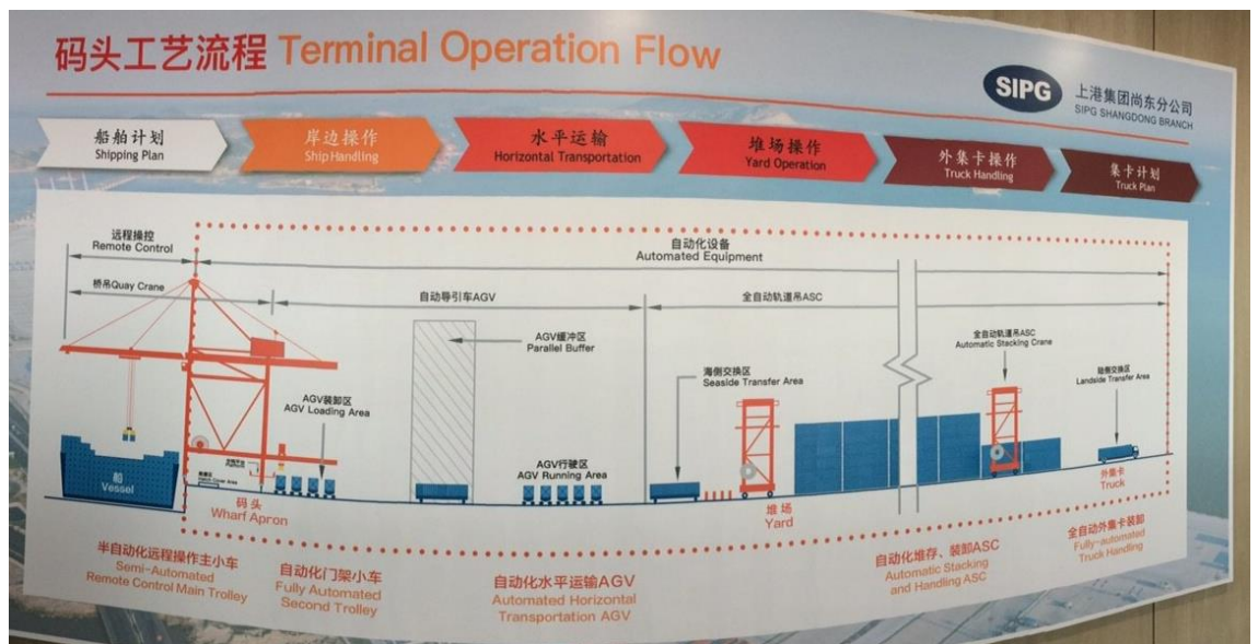
圖 11 上海港洋山四期自動化碼頭作業流程
