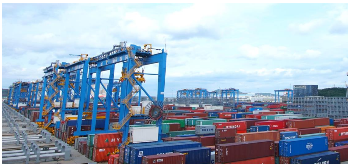
圖 29-櫃場作業以高速軌道吊桿完成任務
