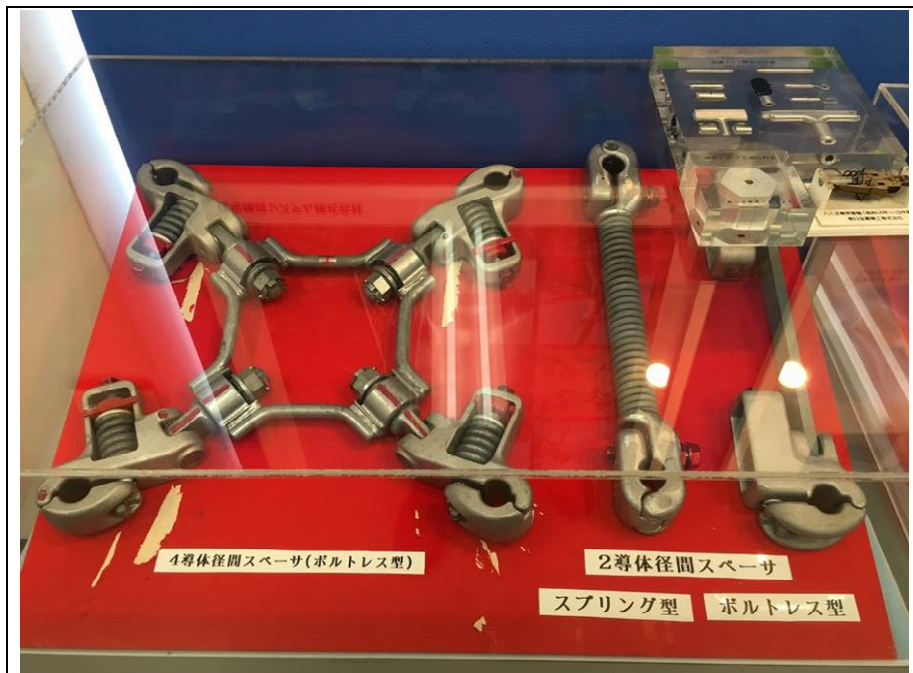
圖 3、左為四導體用間隔器；右為複導體用間隔器
