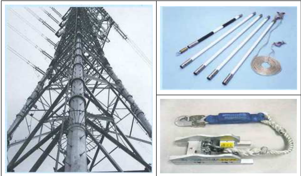
圖 2、左為鐵塔用防止墜落裝置；右上為接地工具；右下為升降用安全器
