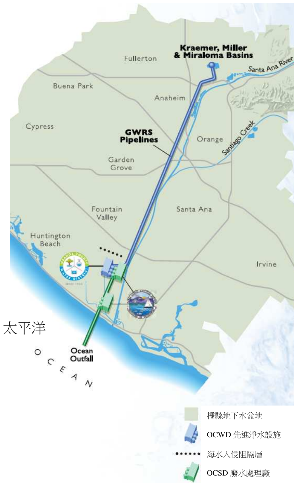
圖 3 地下水補注系統相關設施位置圖
