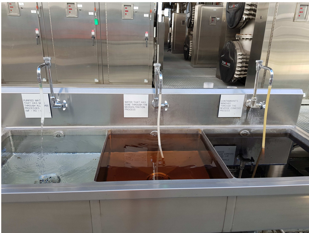
圖 14 處理後之水質（左：最終水質、中：微過濾後水、右：逆滲透之濃縮液）
