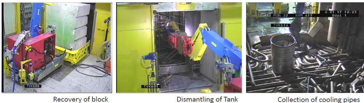
圖八、KTE 燃料再處理場 WAK HLLW 遠端拆解除役
