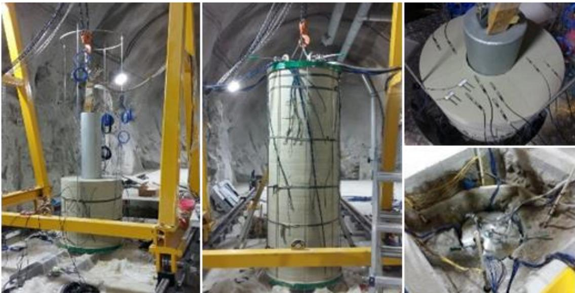
圖 48 : KURT 縮尺工程障壁 EBS THM 耦合試驗
