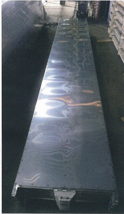
圖三十一、點焊完成後的集塵極板元件(55kg/片)
