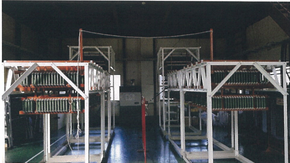
圖三十四、靜電集塵器的電場模擬器
