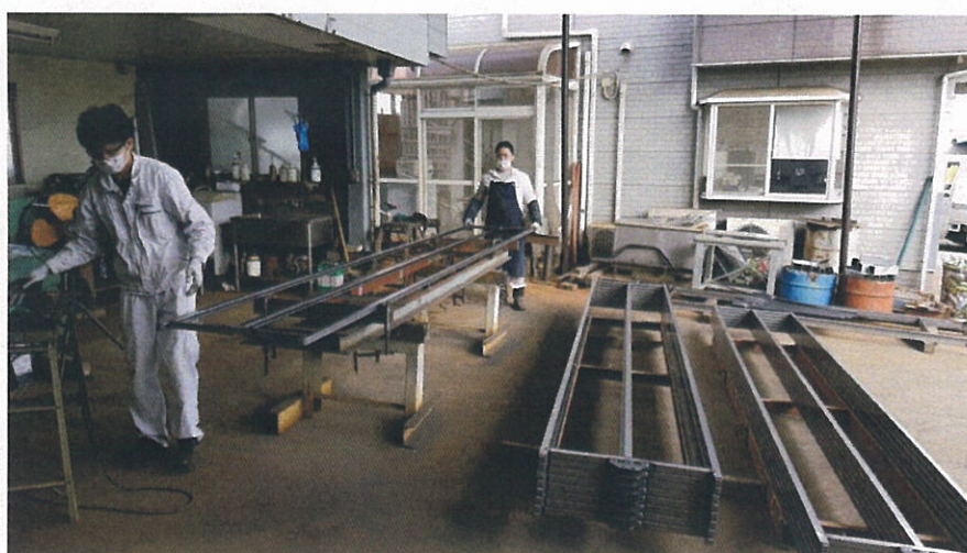
圖二十七、MEEP 集塵極板框架製造
