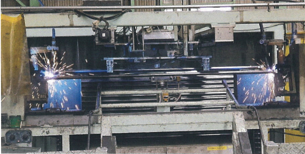
圖二十一、極線框部件使用自動銲接機器
