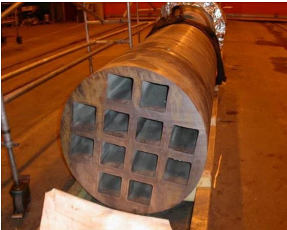
圖 53-鑄鐵內襯完成圖
