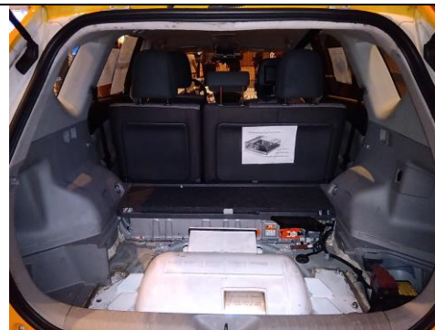
LPG 氣電車 Toyota Prius V (CT 200h) 先進的雙燃料系統(LPG 儲氣桶及電池)
