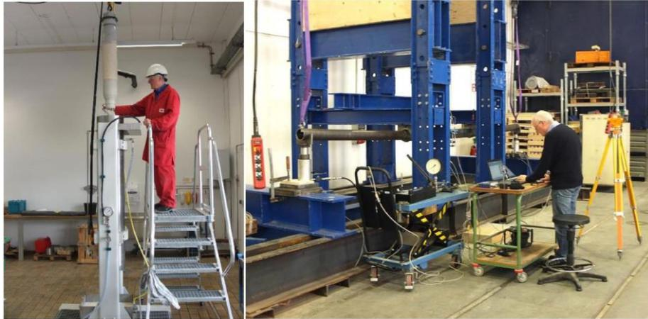
圖 17 陶瓷篩管衝擊測試與撓曲測試
