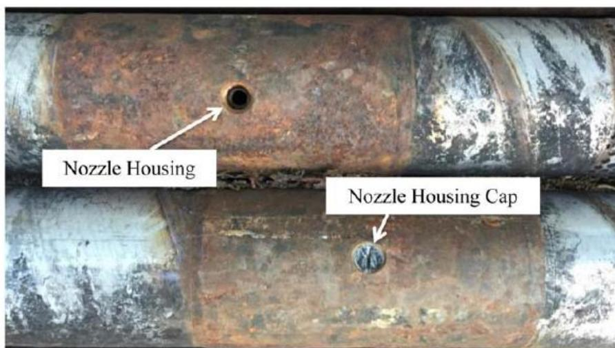
圖 1 流入控制裝置表面安裝噴嘴的孔洞及外蓋
