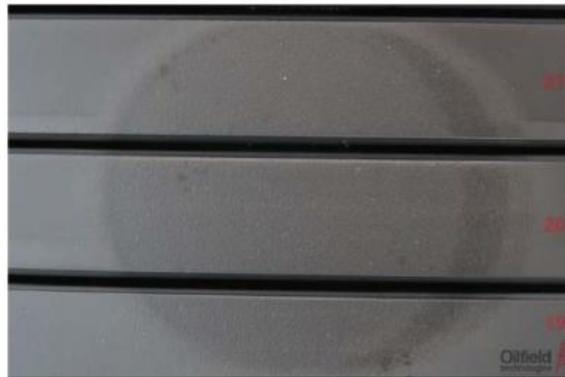
圖 14 經 48 小時磨蝕試驗後陶瓷篩管
