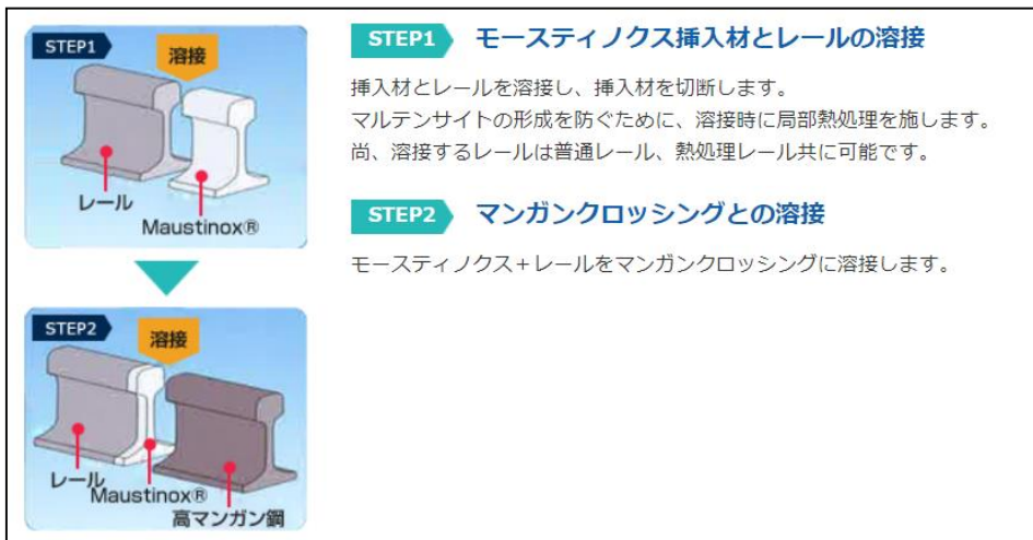
圖 15 高錳鋼岔心焊接步驟圖
