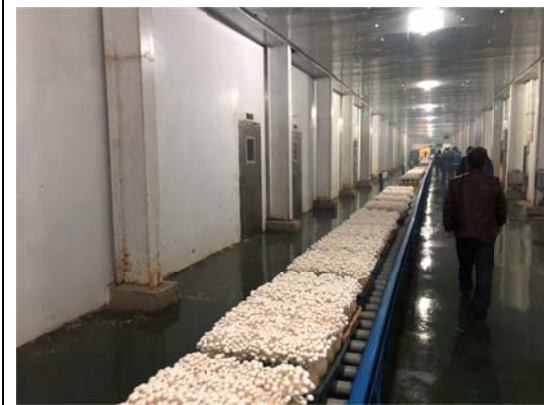
圖 15.利用瓶栽自動化生產菇類
