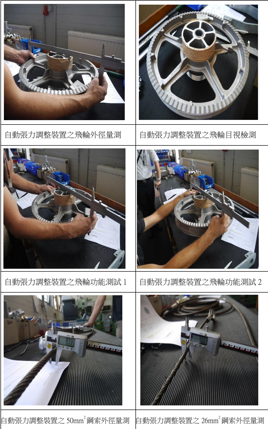
圖 4-2 自動張力調整裝置中間檢查作業
