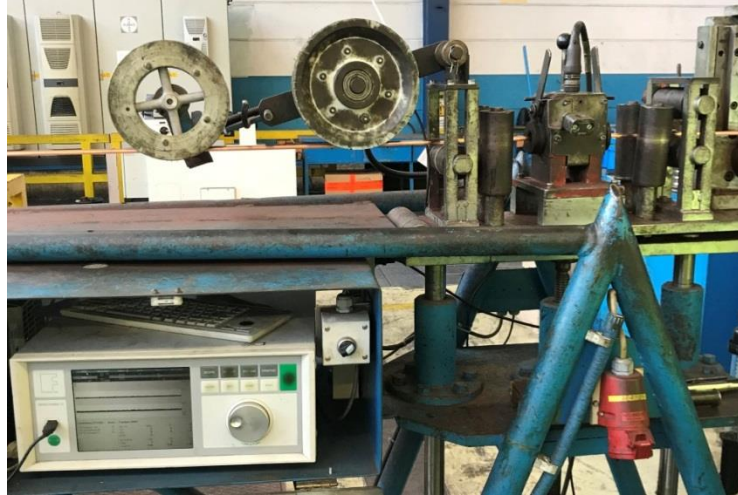
圖 3-8 渦電流檢測設備照片
