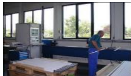
玻璃纖維絕緣棒彎曲試驗
