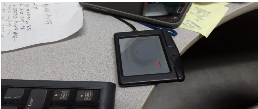
圖 4：Joanna 女士所使用之類似筆記型電腦的滑鼠板，使用者只需以手指在小範圍內滑動，即可移動滑鼠，可提供手腕關節移動困難之人士使用。
