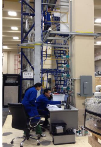
圖 2 小型整體效應測試設施
