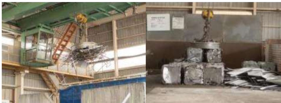
▲巨型磁鐵進行廢棄金屬分類(左)與壓縮加工後之金屬鐵塊(右)
