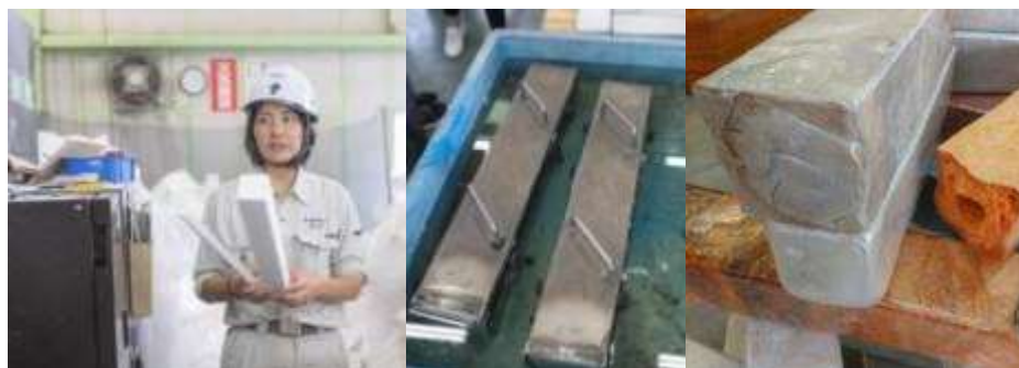
▼保麗龍溶解熔爐(左)與冷卻靜置(中)級固化後保麗龍(右)
