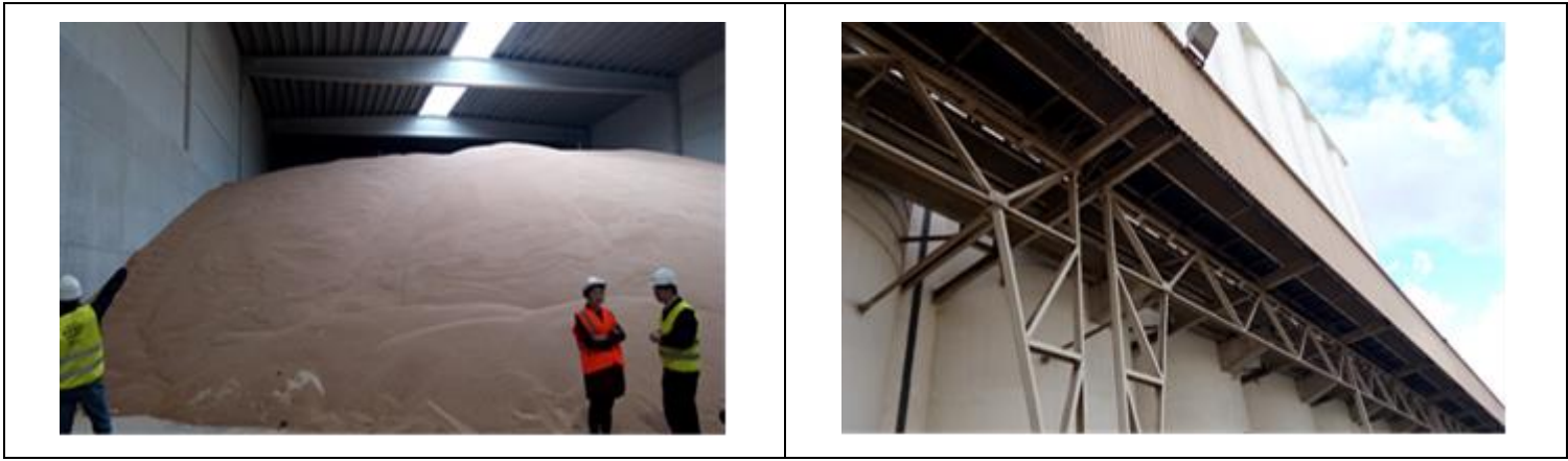
圖 21 整修的穀類倉庫，右圖連通各儲槽之帶狀密閉式輸送帶(資料來源：自行拍攝)
