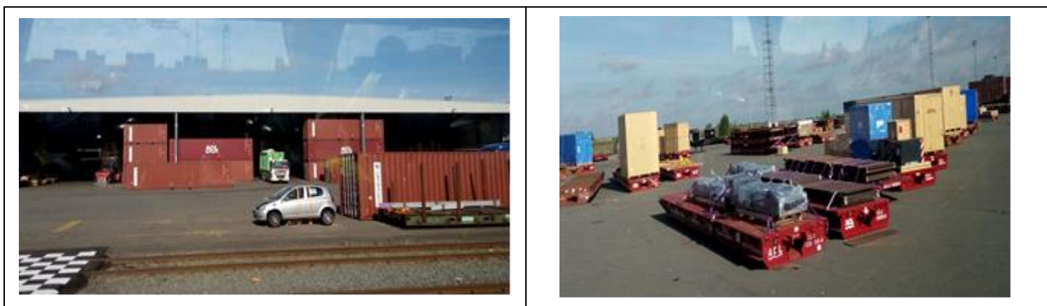
圖 24 進行貨物繫固 MAFI(RoRo 船使用的特殊拖車)的倉棧，右圖為繫固完成的 MAFI
