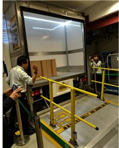
圖 12 貨車尾板安全裝置
