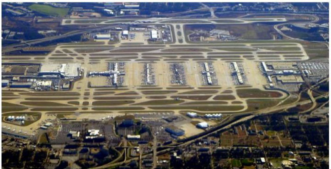
圖 3-15 以衛星型設計之航廈案例
