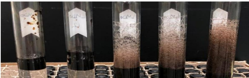
圖 10、相同量的表面活性劑濃度，泡沫在 400 分鐘後衰減，但聚合物的量從左到右增加。
