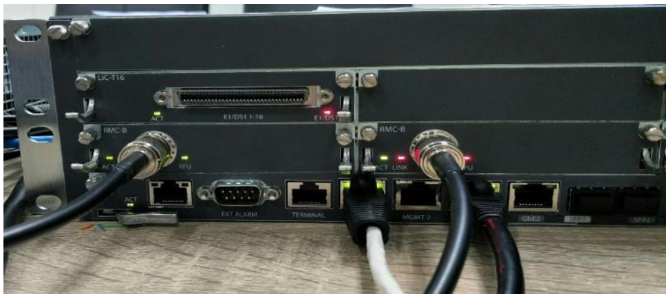
圖 6-6 亦可藉由設備燈號判斷可能故障原因
