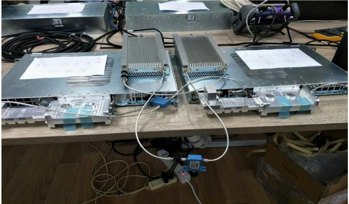
圖 6-4 串聯可調式衰減器，模擬傳輸路徑
