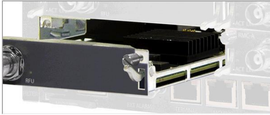
圖 2-36 Radio 介面卡安裝
