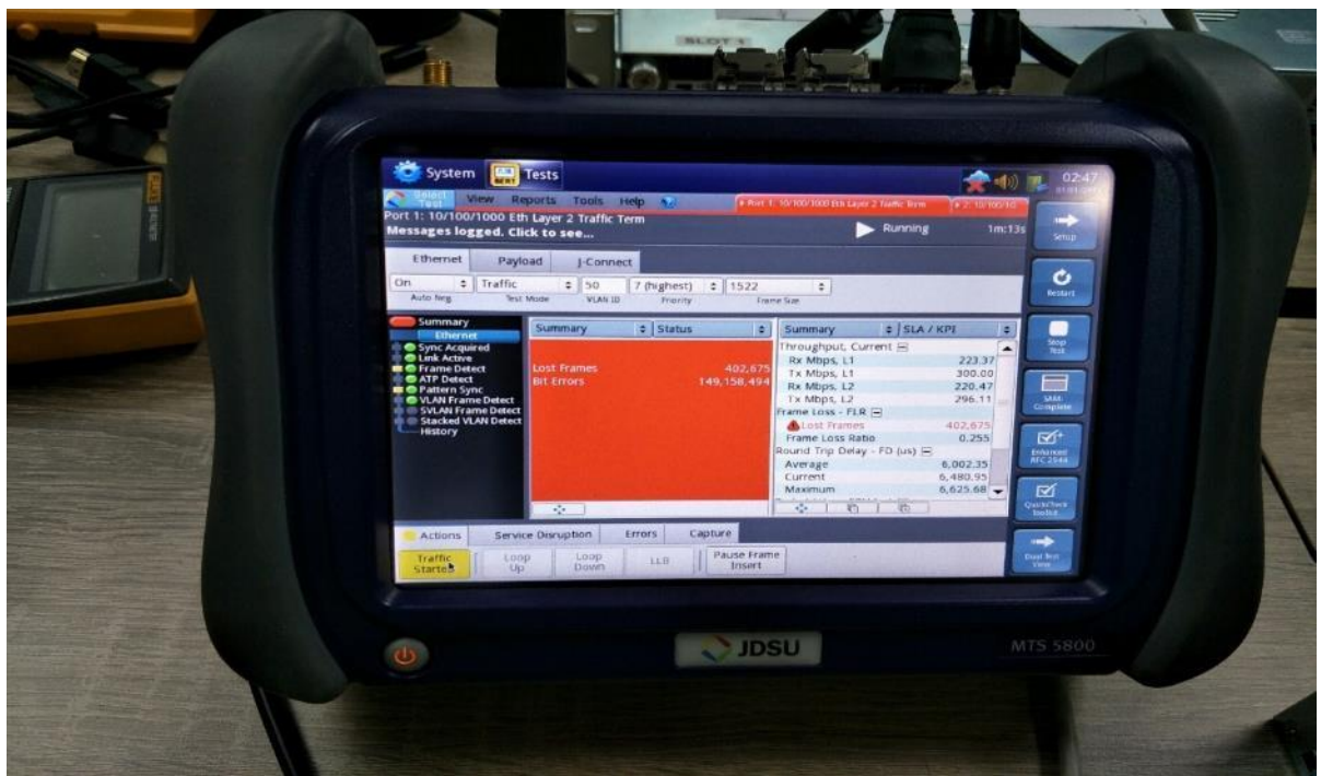
圖 6-3 在講解建立 Ethernet 設定時，以儀表實測 Ethernet 電路通聯情形
