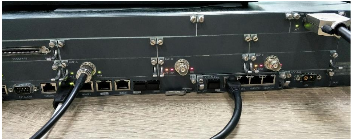
圖 6-9 藉由設備燈號不亮判斷可能為網路中斷
