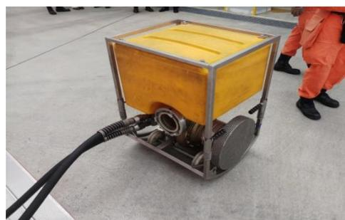
圖 111 可用吊臂將抽水幫浦放置 50M 落差處
