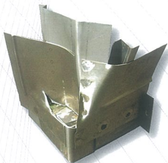
▲SUS部分车体结构的冲击试验结果
