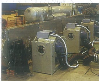
▲确认超导磁铁耐久性的试验
