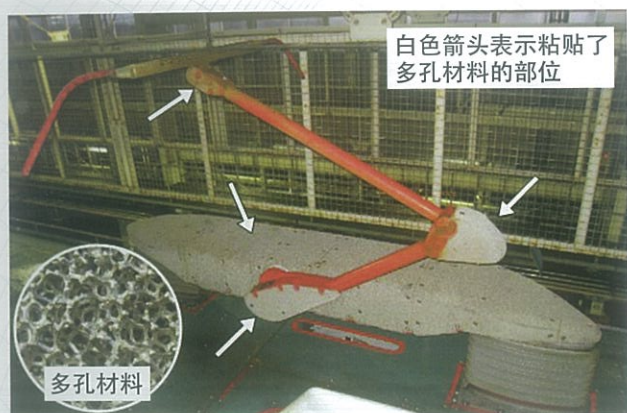
▲在受电弓上应用多孔材料的示例
