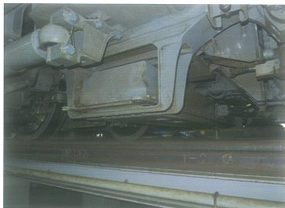
▲安装在新干线上的检测装置示例
