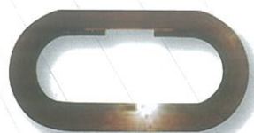
▲使用高温超导线材的小型超导线圈
