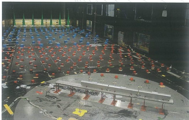
▲模拟自然风的风洞试验
