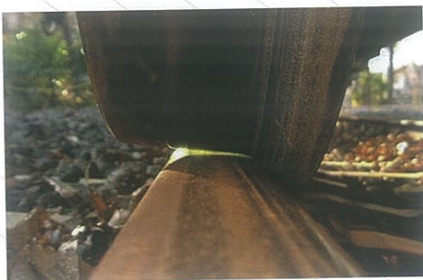
▲研究所内进行的脱轨行车试验
