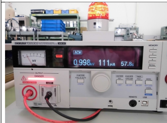
Photo 17: 耐電圧試験中の耐電圧・絶縁抵抗試験器 (3F0059)
