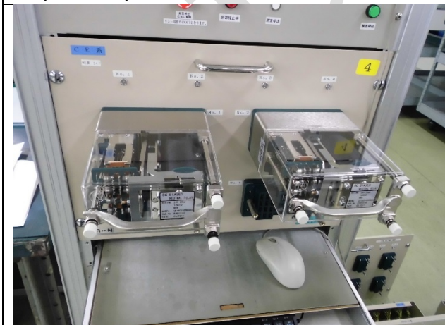
Photo 19: 直流リレー自動試験器で測定中の安全リレー
