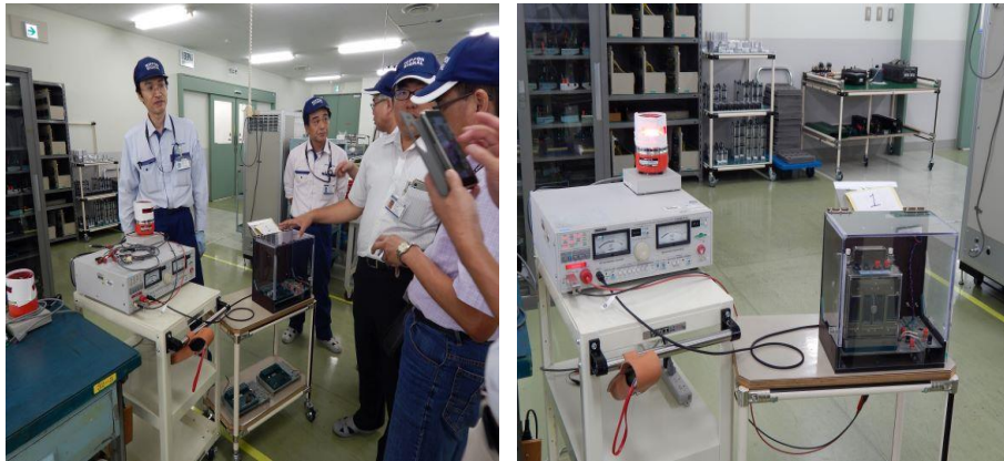
圖 3-11 繼電器絕緣及耐壓測試
