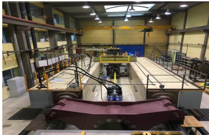
圖 3-22 鋼纜疲勞試驗設備
