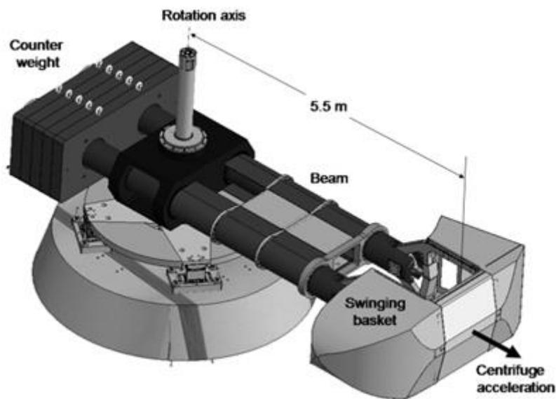
圖 3-18 土工離心機配置圖
