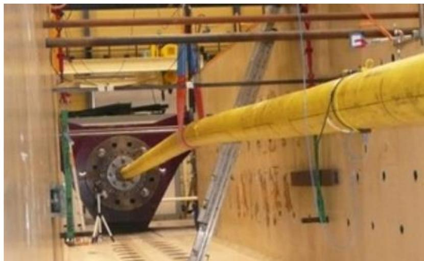
圖 3-23 鋼纜疲勞試驗設備彎曲應力試驗
