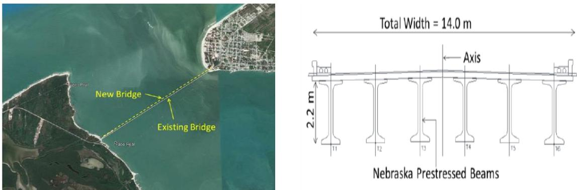
圖 3-49 La Unidad 橋位置示意圖及橋梁型式
