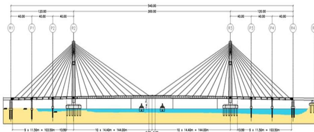
圖 3- 30 Rod El-Farag 斜張橋跨徑配置
