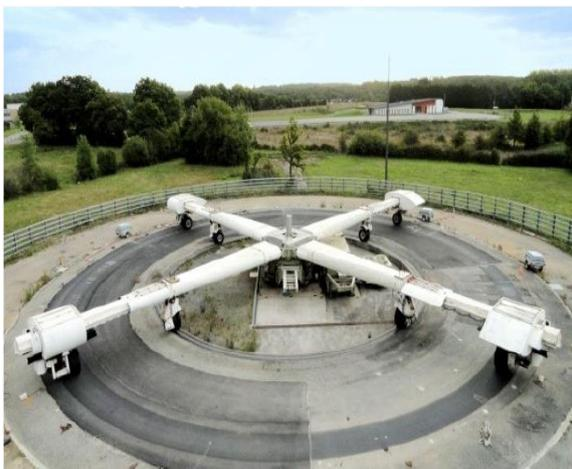
圖 3-20 路面疲勞試驗軌道
