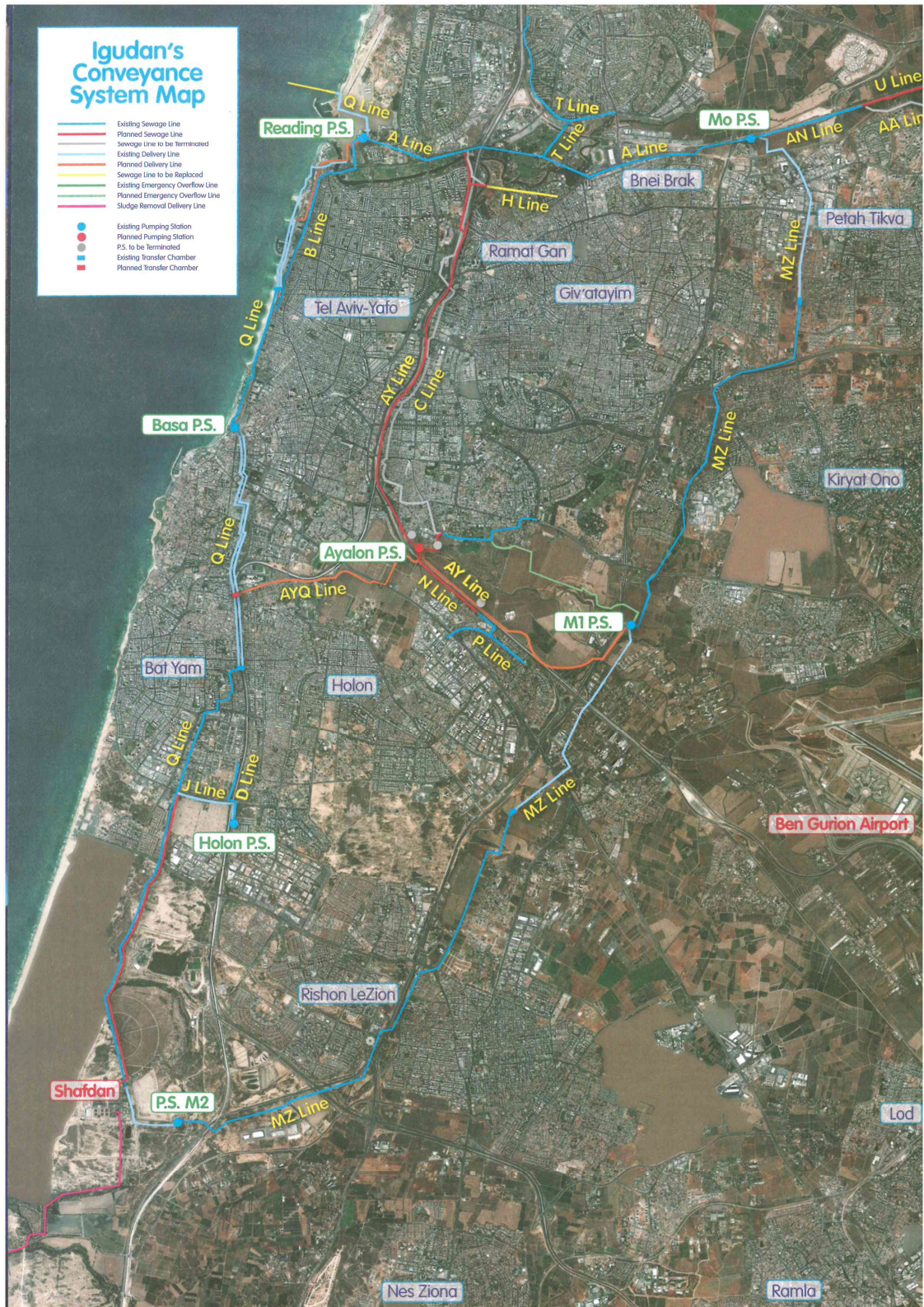
Shafdan 污水廠污水傳輸管路系統圖
