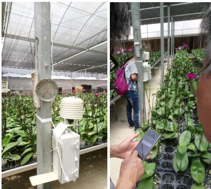
前期於越南大叻台商蘭園設置之環境記錄器，本次現場以手機測試接收雲端資料。
