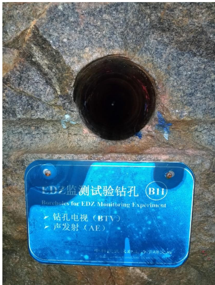
圖 25：側坑監測坑室試驗鑽孔與試驗項目說明
