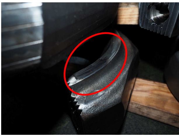
#6 機 A7 大端側面磨損位置
