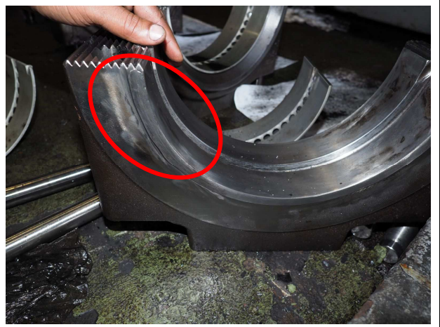
#6 機 B7 大端側面磨損位置(已修復)
