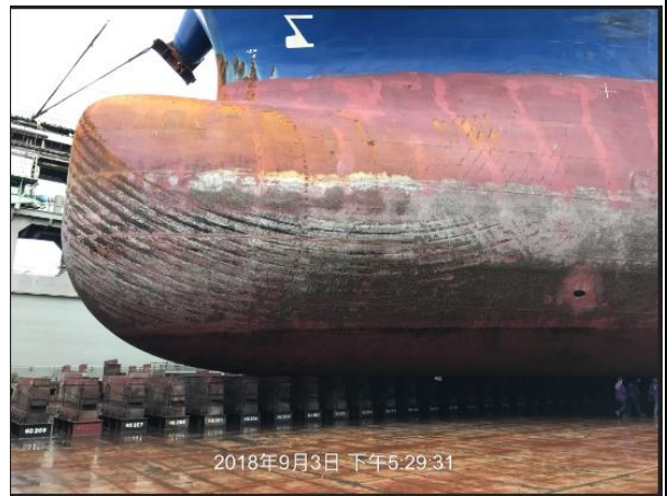
高壓水柱清洗船殼
