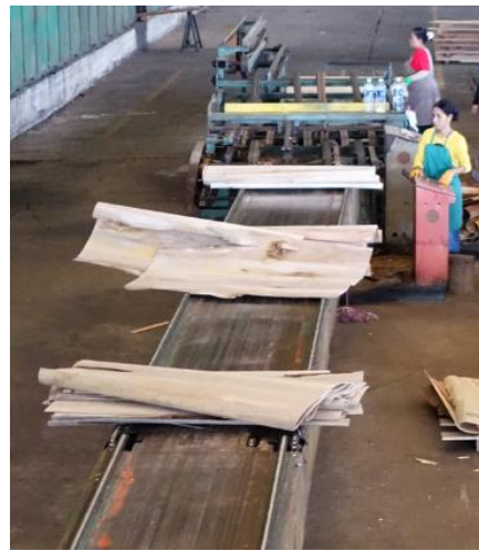
木條利用機器裁切成木片，將完整與破損的木片分開收集。
