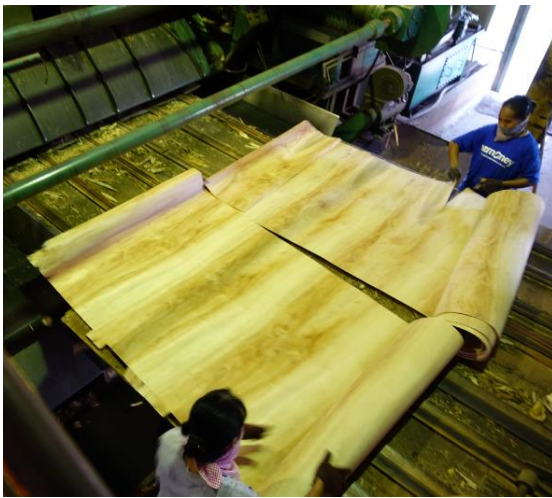
木條利用機器裁切成木片，將完整與破損的木片分開收集。
