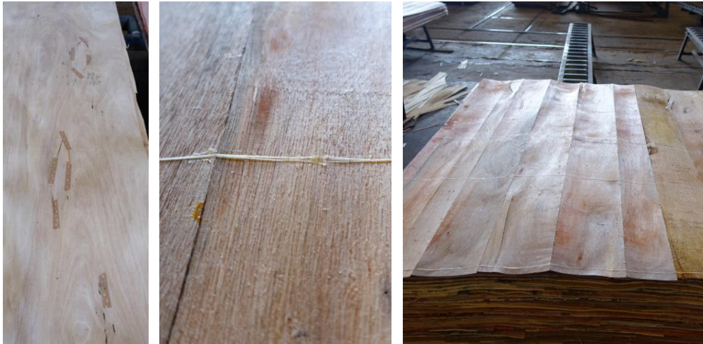
使用於中間層的破損木片，需以膠帶或熱熔膠修補。
