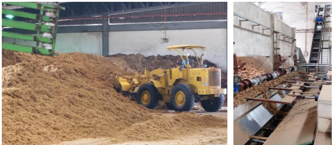
生質廢棄物集中後，以自動產線送至鍋爐作為燃料燃燒使用。
