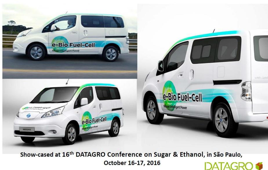
圖 16 巴西 SOFC 燃料電池車
