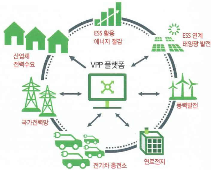
圖二十六、VPP 虛擬發電廠概念圖
