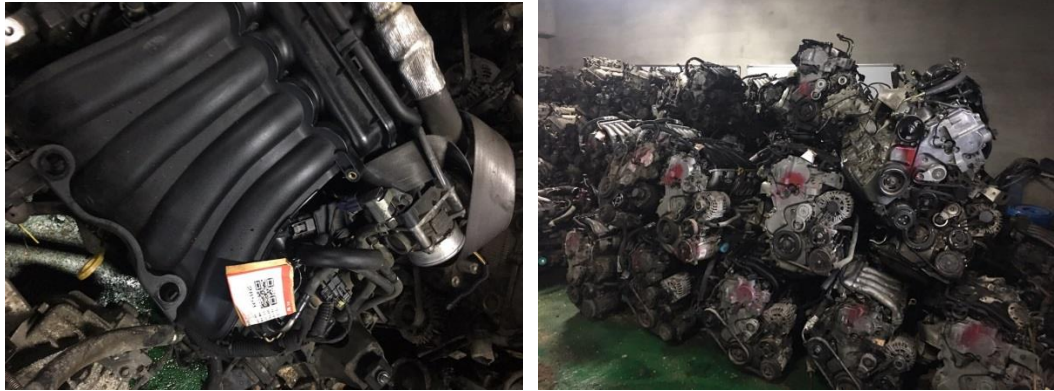
圖十五、二手零件註記方式(左側為 QRcode、右側為噴漆註記)
