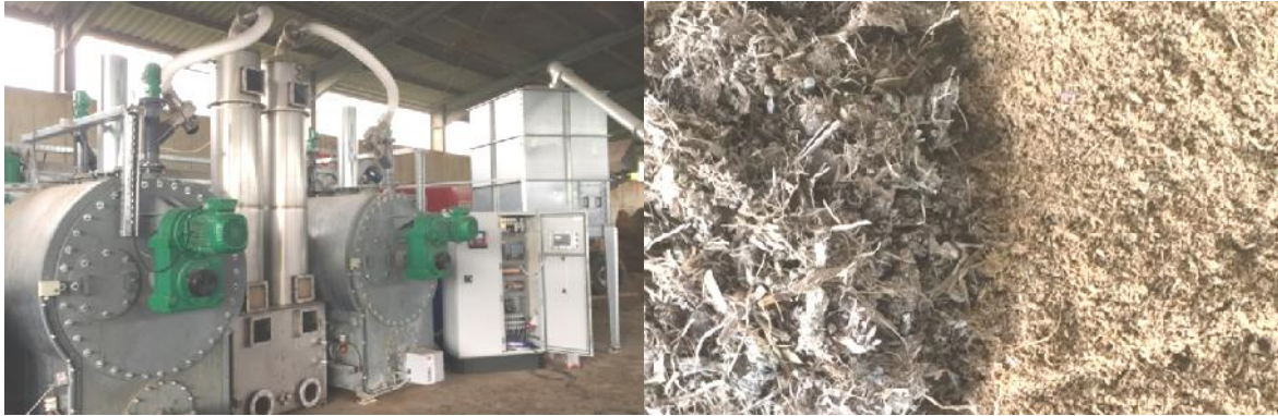
Abbildung 1: Großtechnische Versuchsanlage / Hähnchenmist unbehandelt (links) und nach der Konditionierung mit Branntkalk (rechts)
