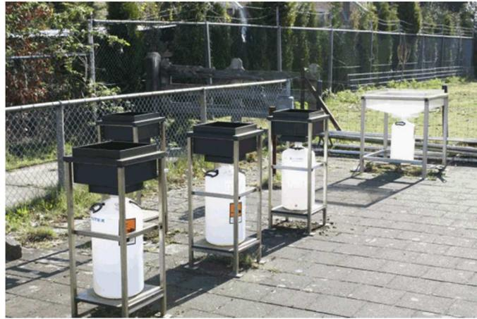
圖 9 荷蘭 RIVM 乾溼沉降採集器設置實景
