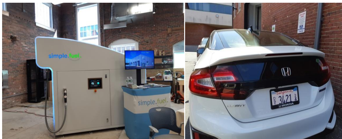
IVYS Energy Soutlion 展示之電解水產氫 Toyota Mirai 及 Honda Clarity 燃料電池車 使用其加氫站加氫
