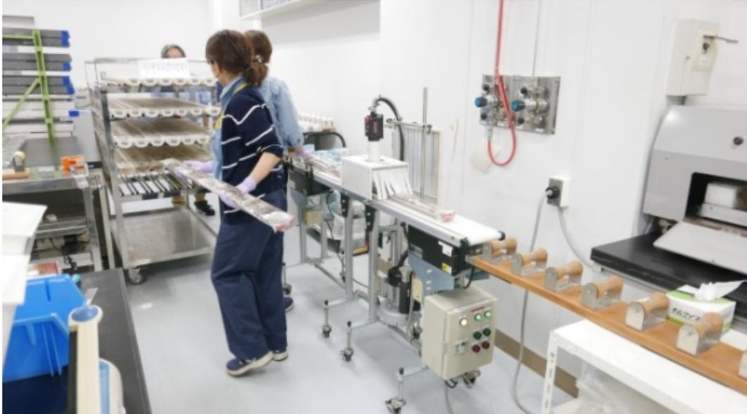
圖 7、岩心包膜作業與岩心包膜後待裝入 D 型管保存、入庫
