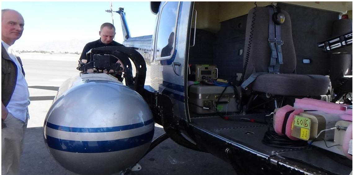
圖 24 直升機 Bell 412 裝載空中輻射偵測系統(AMS)設備
