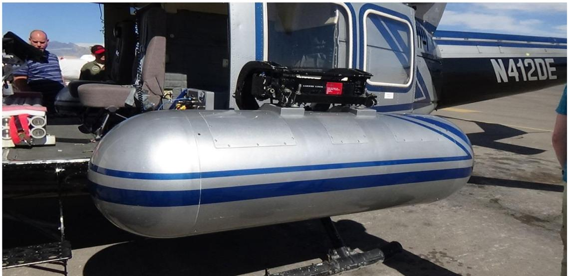
圖 25 直升機 Bell 412 裝載空中輻射偵測系統(AMS)設備
