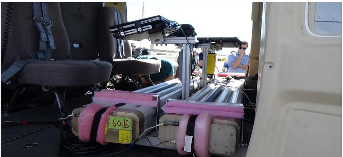
圖 23 直升機 Bell 412 裝載空中輻射偵測系統(AMS)設備
