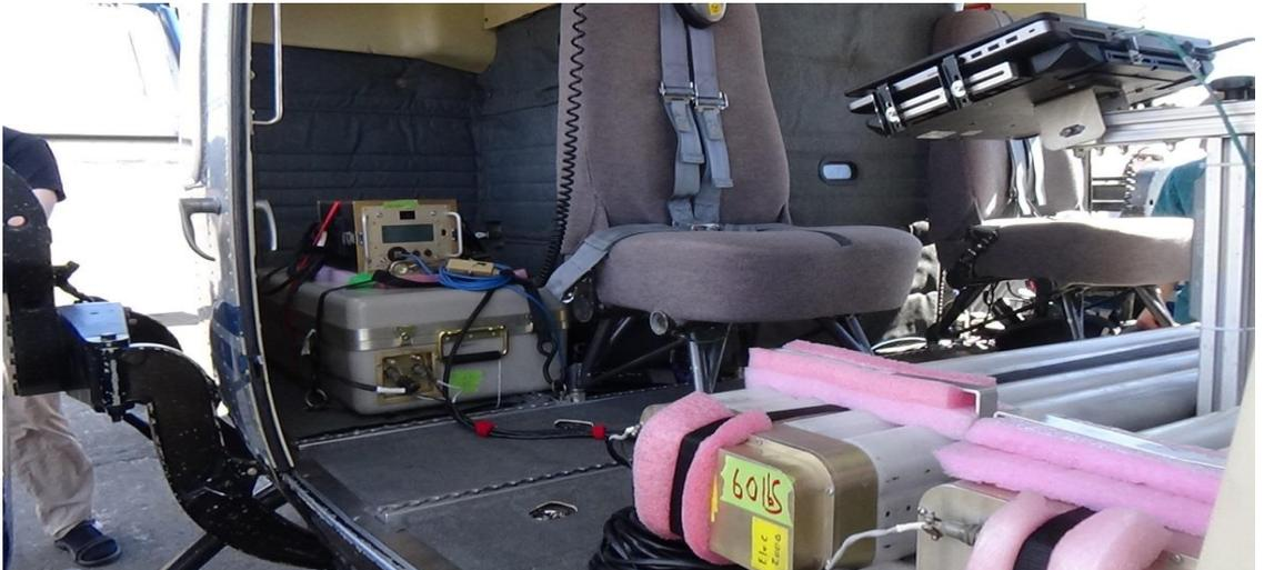
圖 22 直升機 Bell 412 裝載空中輻射偵測系統(AMS)設備
