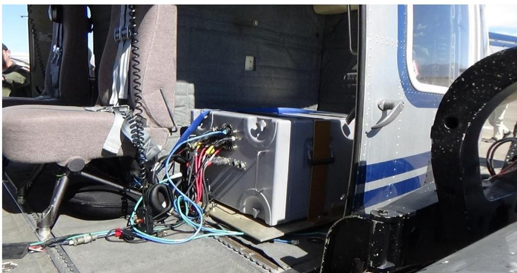
圖 26 直升機 Bell 412 裝載空中輻射偵測系統(AMS)設備
