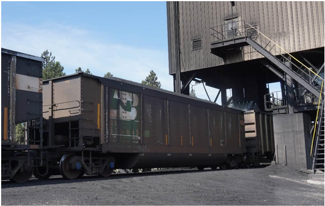
圖53 Signal Peak礦區火車裝煤作業
