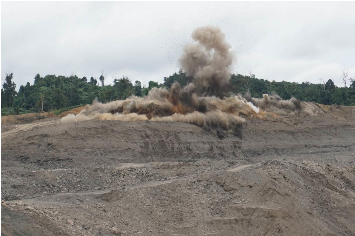
圖17 Tambang Damai礦區覆土爆破作業
