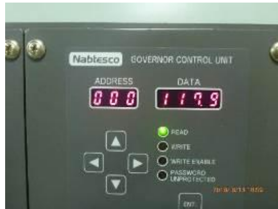
主機加速中，當時主機轉.117.9 RPM
