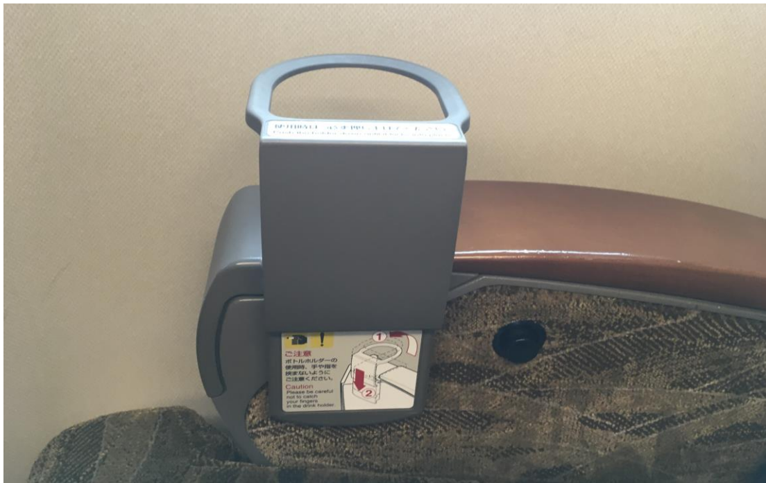
圖55 杯架設計在座椅扶手上使用時托起
