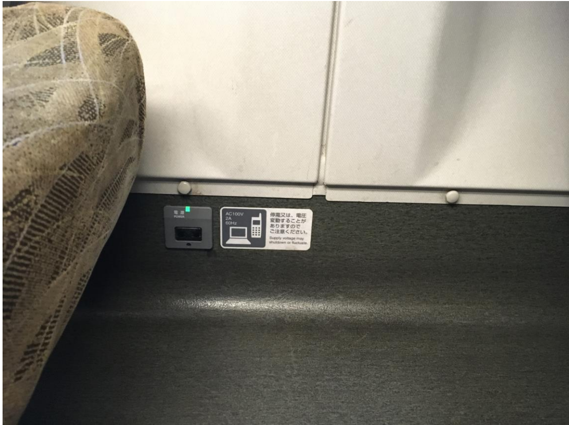
圖61 電源插孔設置座位邊方便使用
