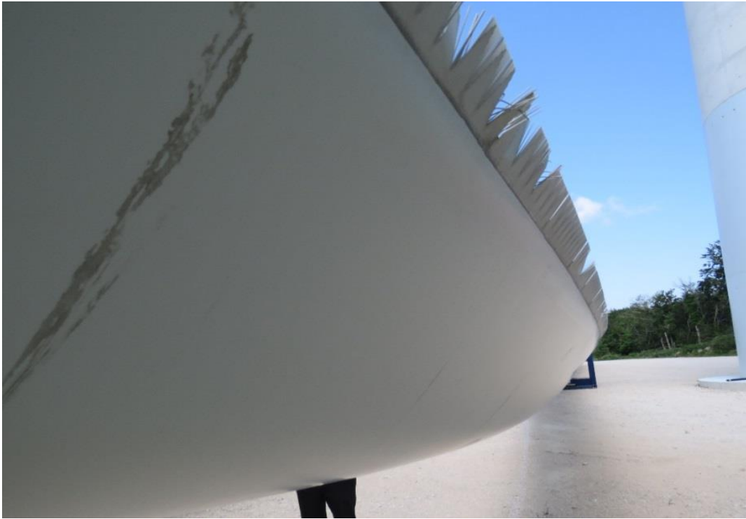
圖 54 具減噪(音)功能之風力機葉片葉緣設計
